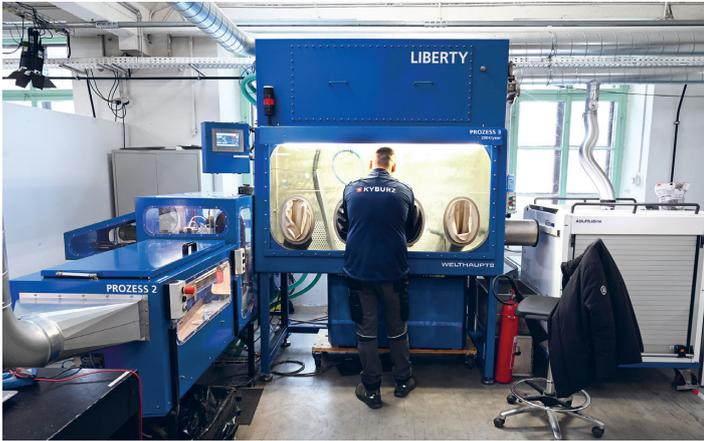
Abbildung 2: Einspannen der Batterie für das Recycling
